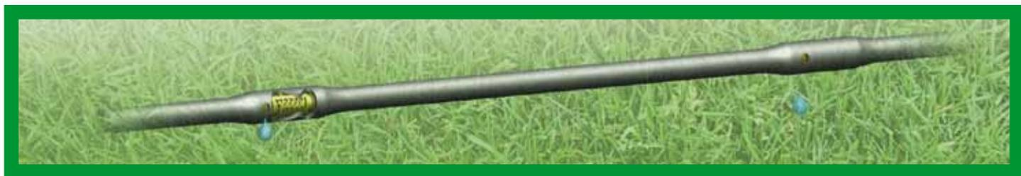
Die Gesamtlänge des Tropfrohres ist so zu bemessen, dass der letzte Tropfer einen Minimaldruck von 0.2bar erreicht, um den tropfereigenen Spülmechanismus zu erreichen.
