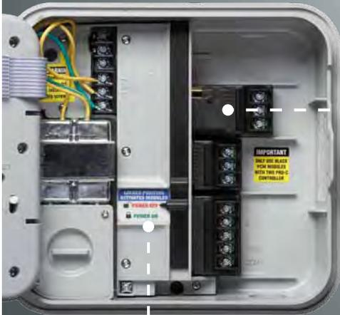
Grundgerät für 3 Stationen, erweiterbar auf 15 Stationen mit PCM-Modulen.
